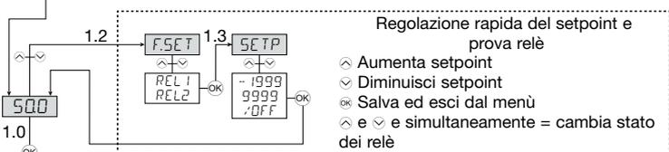
Regolazione rapida del setpoint e prova relè
